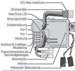
**HINWEIS:** Die Antenne nicht schneiden, knicken oder modifizieren. Schäden an der Antenne oder ein Kürzen verringern den Bereich.
